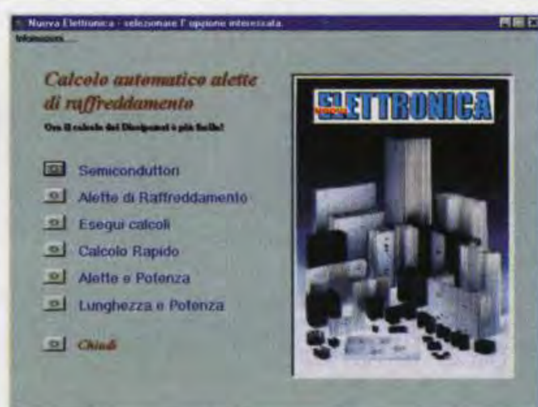
Fig.2 Caricato il programma nell'hard-disk avete a disposizione 6 opzioni per calcolare la lunghezza dell'aletta.
