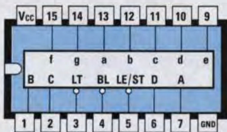
Fig.615 Schema interno di una Decodifica per pilotare i display. I piedini con le lettere minuscole a-b-c-d-e-f-g vanno collegati ai terminali a-b-c-d-e-f-g del display. I piedini A-B-C-D sono quelli d'ingresso.
