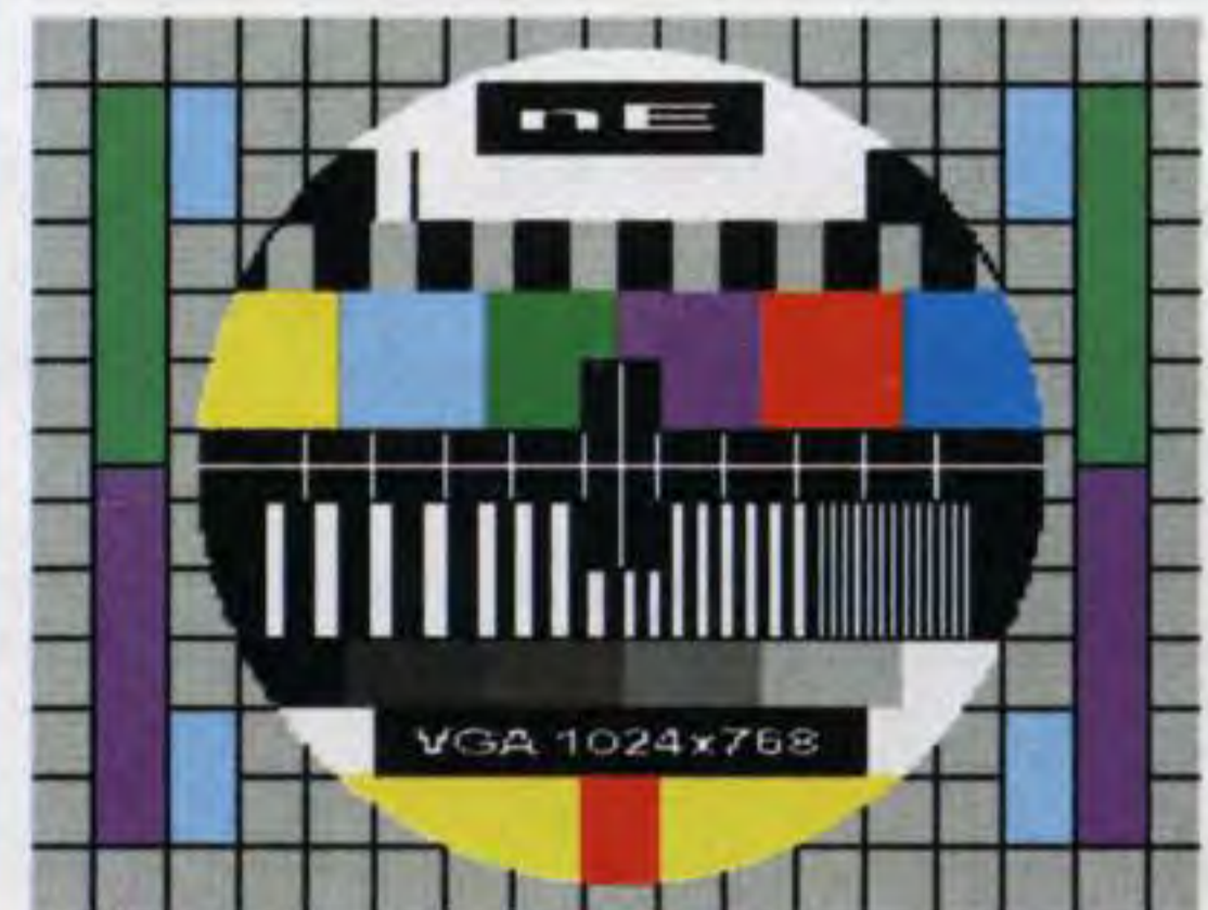
Fig.1 In alto il monoscopio visibile sullo schermo di un TV e sotto sullo schermo di due diversi monitor per Computer. Molte schede grafiche accettano, oltre al formato 640x480, anche il formato 1024x768.
