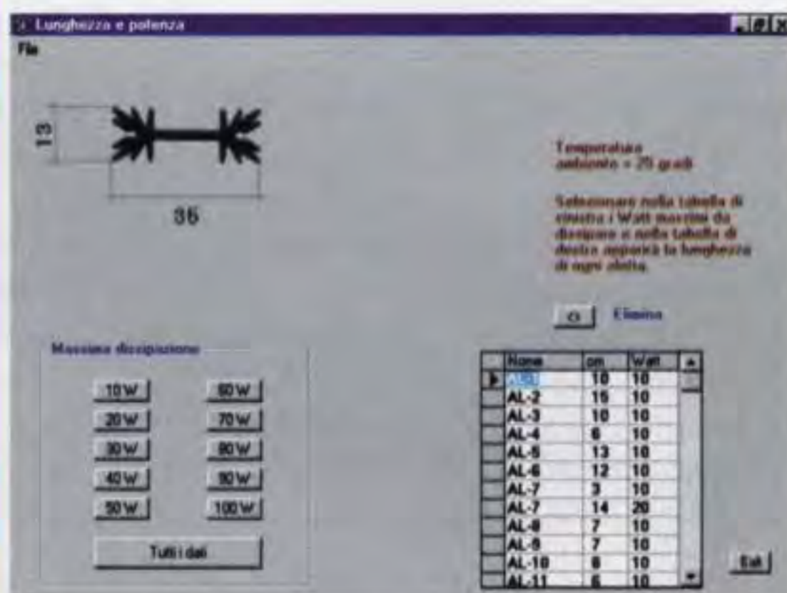
Fig.23 Con l'opzione Lunghezza e Potenza, scelta la potenza da dissipare, sulla destra appare la lunghezza in centimetri.
