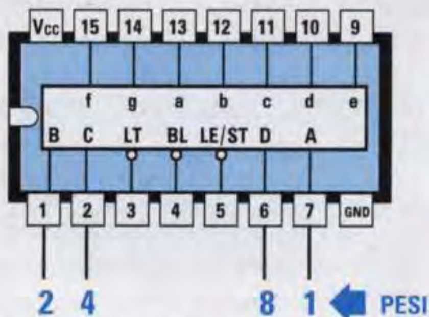
Fig.616 Collegando i piedini A-B-C-D ad una tensione positiva, sui display si accenderà un numero corrispondente al loro Peso. Piedino A peso 1, piedino B peso 2, piedino C peso 4, piedino D peso 8.
