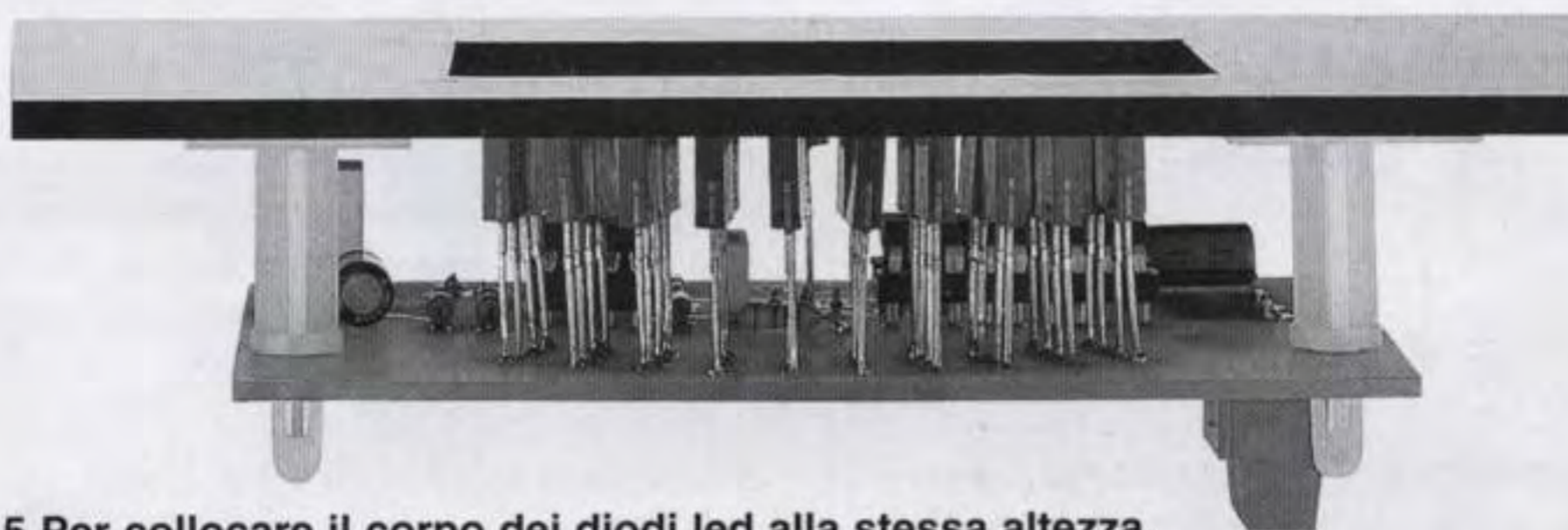
Fig.5 Per collocare il corpo dei diodi led alla stessa altezza, conviene prima fissare il circuito sul pannello del mobile, poi appoggiare i loro corpi sul plexiglas rosso.
