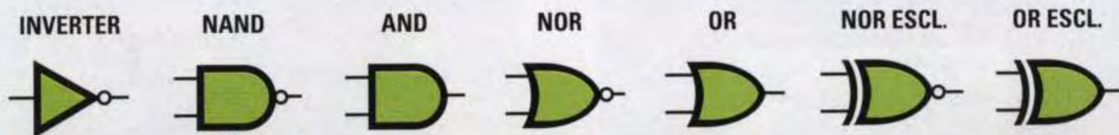
Fig.646 In questo disegno riportiamo i simboli grafici di tutte le porte digitali come li vedrete disegnati negli schemi elettrici. Come potete vedere nella Tavola della Verità riportata in fig.647, applicando sugli ingressi di ogni porta una diversa combinazione di 1-0 otterrete sulle loro uscite un diverso livello logico.
