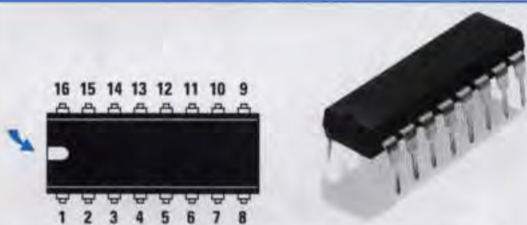
Fig.613 Per individuare i piedini 1-8 e 9-16 sul corpo dell'integrato è sufficiente rivolgere la tacca a U verso sinistra. In questa posizione, il piedino 1 si trova in basso a sinistra e l'8 in basso a destra.
